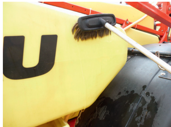
Abbildung 5: So reinigen Sie die Pflanzenschutzspritze auf dem Waschplatz Ihres Betriebs (a), auf dem Feld (b, c) (© Garrelts)
